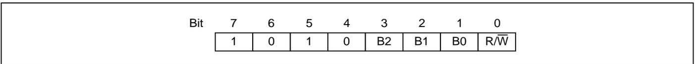
**Figure 5-6. Byte Write**
