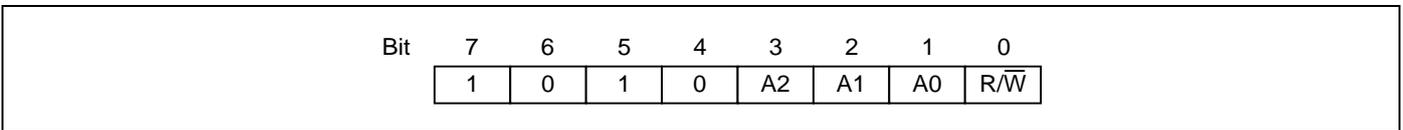
**Figure 5-6. Byte Write**
